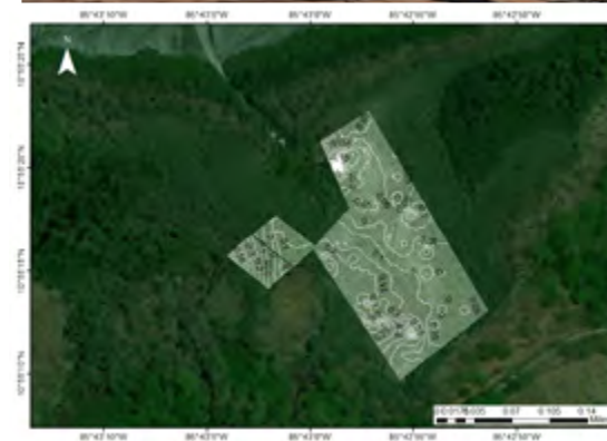
Figure 14. Carte de la microtopographie de la zone à restaurer par la méthode RTK (Cuajiniquil)
