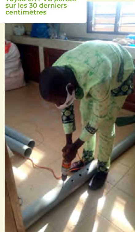
Figure 16. Installation de tuyaux en PVC dans les sous-parcelles de reboisement pour la collecte d'échantillons d'eau et la mesure des paramètres physico-chimiques in situ , conformément à Agraz Hernández et al. (2007). © C. Agraz Hernández
