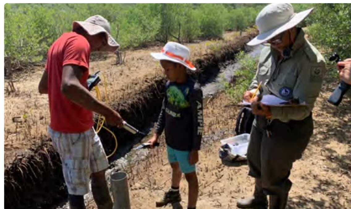
Détermination de la salinité, du potentiel redox, du pH et de la température de l'eau interstitielle dans une forêt d'Avicennia germinans sur un site en Amérique Centrale. © C. Agraz Hernández
