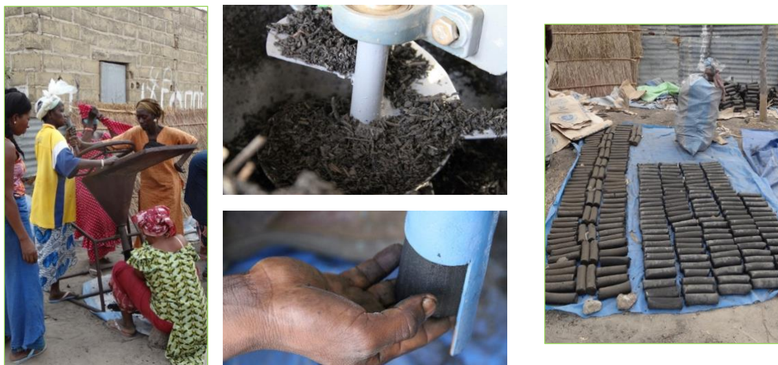
Figure 5: Agglomération du poussier à l'aide d'un rotor presse manuel et séchage des briquettes
