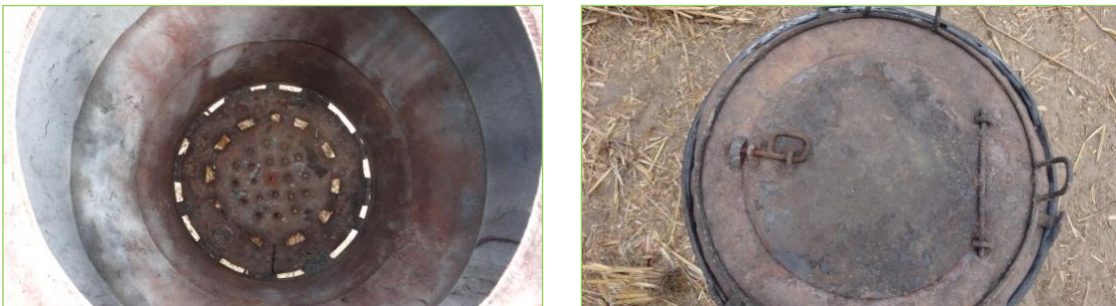
Figure 2: Fût métallique transformé : trous d'aération (à gauche) et couvercle de fermeture (à droite)
