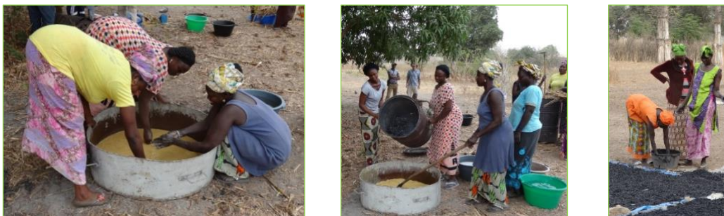
Figure 4: Préparation du mélange eau+argile (à gauche), ajout de la paille carbonisée (au centre) et séchage (à droite)
