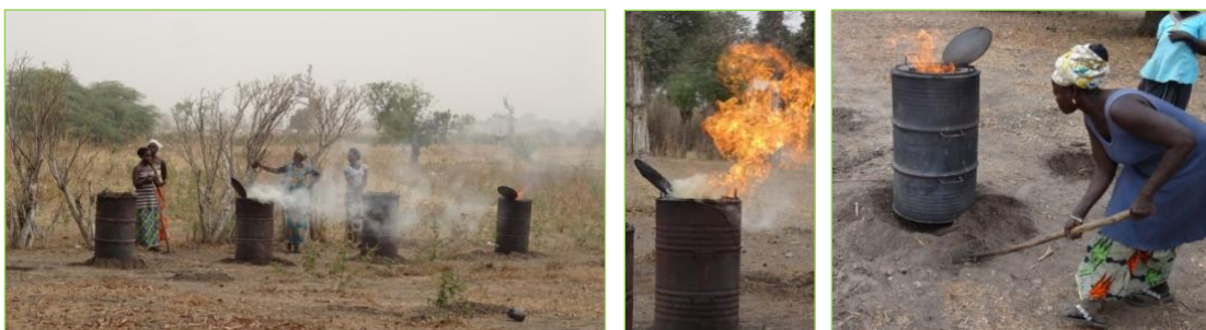
Figure 3: Organisation de la carbonisation (à gauche), combustion des gaz (au centre) et obturation des événements (à droite)
